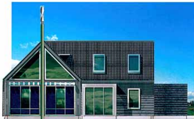
Het Tangramhuis van prijswinnaar Stache Architect (houten portaalspanten, ingevuld met hsb-wanden). Hier de uitvoering met houten gevelbekleding.
